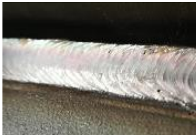
Slika 5: MAG varjenje, nerjavna pločevina 304, kotni zvar, povečan
