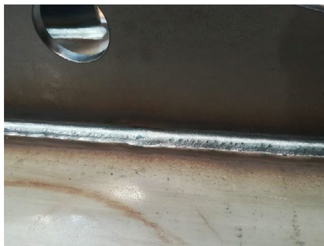
Slika 6: MAG varjenje, lužena pločevina DD12, uporaba namenske mešanice
