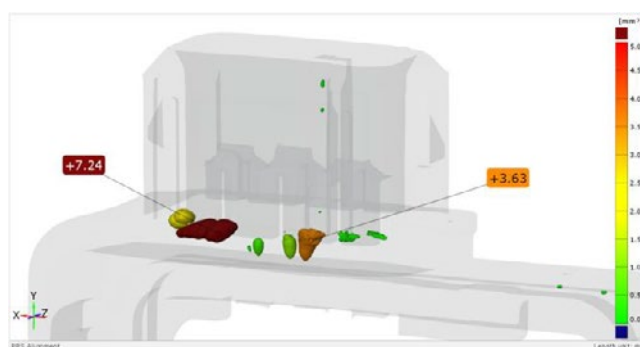
Slika 6: Analiza volumena uključina (lunkera)
