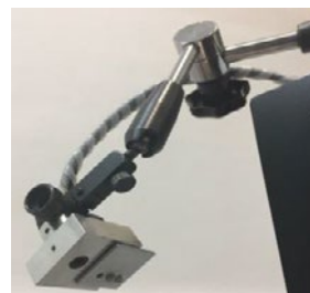
Slika 6: Brezdotično IR temperaturno zaznavalo na gibljivem nosilcu.
