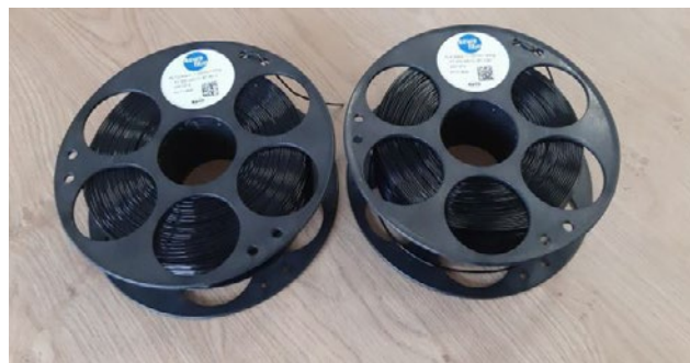
Slika 10: Koluta iz biokompozita rPP/odpadni papir/PP-g-MA za filament za 3D tisk
