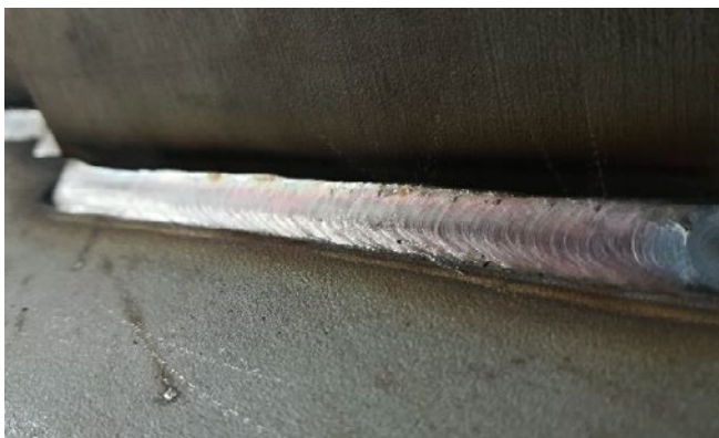
Slika 4: MAG varjenje, nerjavna pločevina 304, uporaba namenske mešanice
