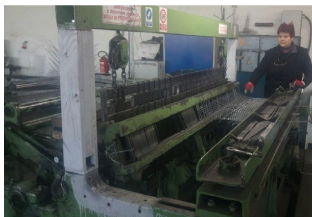
Slika 2: Ročno vstavljanje prečnih žic na polavtomatskem stroju za tkanje žice
