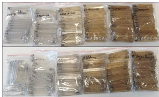
Slika 2: Nabrizgane epruvete za karakterizacijo linerarnega PC (zgoraj) in razvejanega PC (spodaj)
