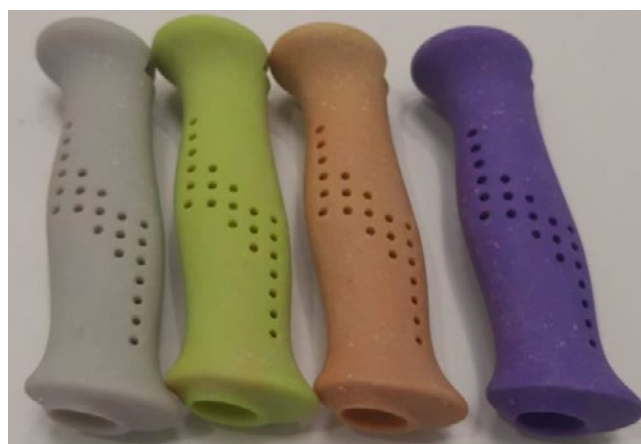
Slika 5: Slika ročajev za smučarske oz. pohodne palice iz termoplastičnega elastomera z dodanim odpadnim papirjem (levi brez barvila)
