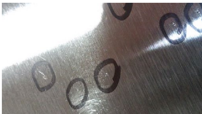
Slika 1: MAG varjenje. Poroznost odkrita po mehanski obdelavi zvarnega spoja.
