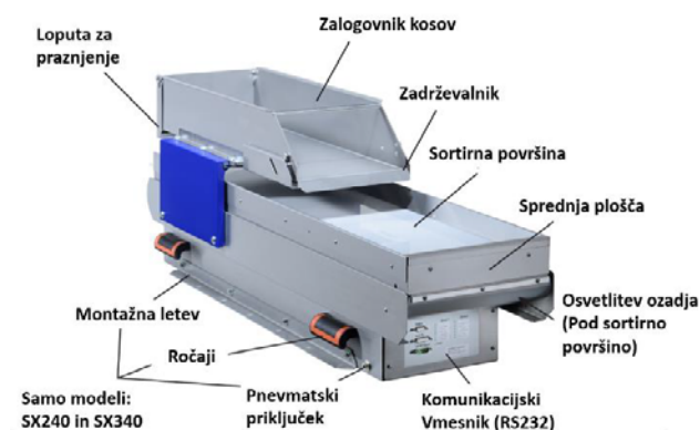
Slika 2: Sestavni deli Anyfeeder naprave
