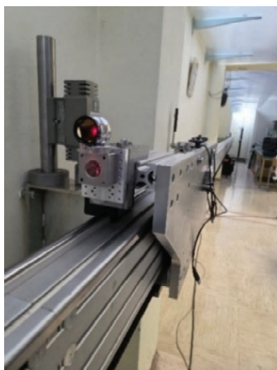
Slika 3: Vpetje optike po Abbejevem načelu
