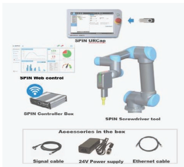
Slika 2: Vijačno orodje CS-30
