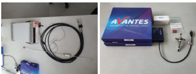
Slika 2: Sonda za merjenje radikalov in optična sonda za merjenje intenzivnosti fotonov
