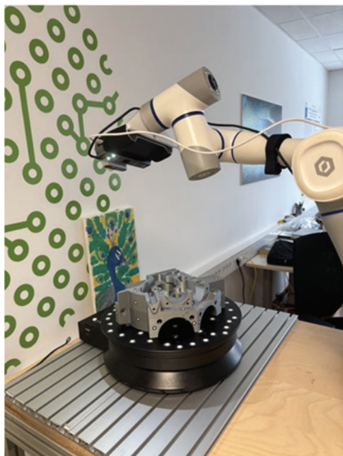
Slika 1: Robot med skeniranjem predmeta na vrtljivi mizi.
