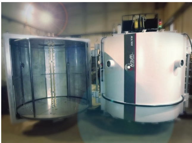
Slika 1: Stroj za visoko vakuumsko metalizacijo, uporabljen za poskus
