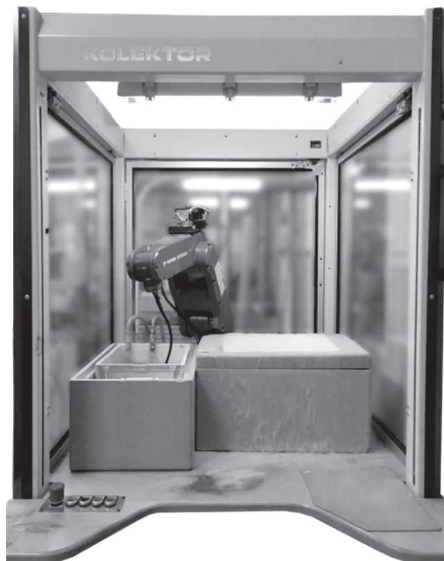
Slika 2: Avtomatizirana tesna celica med izvajanjem temperaturnega šokiranja
