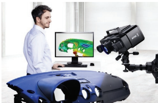
Slika 5: ATOS 3D skener na industrijskom stalku
