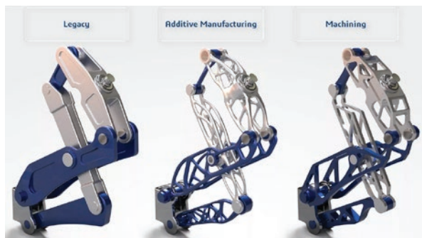
Slika 4: Primerjava klasičnega, generativnega in proizvodno prilagojenega CAD modeliranja komponente [4]
