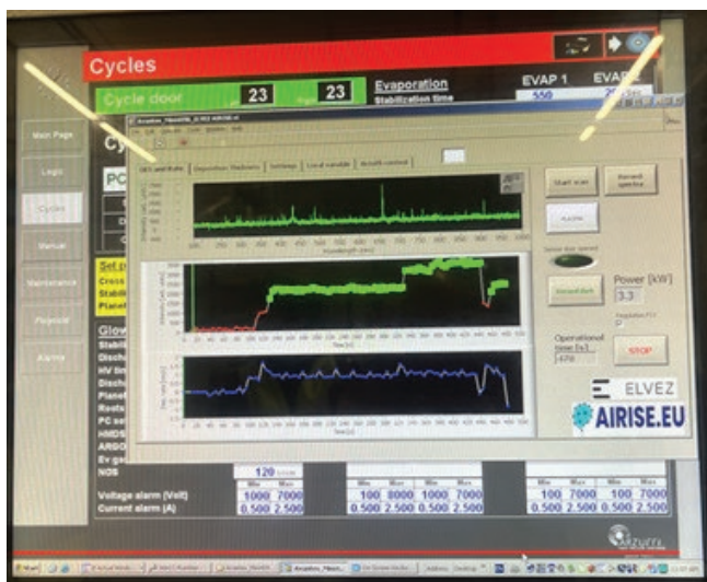
Slika 7: Primerjava procesnih parametrov in prilagoditev glede na izmerjene vrednosti s prilagoditvijo moči plazme navzgor/zmanjša
