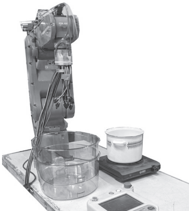
Slika 1: Eksperimentalna metoda šokiranja izdelkov v vodi nadgrajena z robotsko roko
