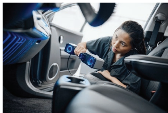
Slika 9: 3D skeniranje za ZEISS T-SCAN hawk 2 ručnim 3D skenerom
