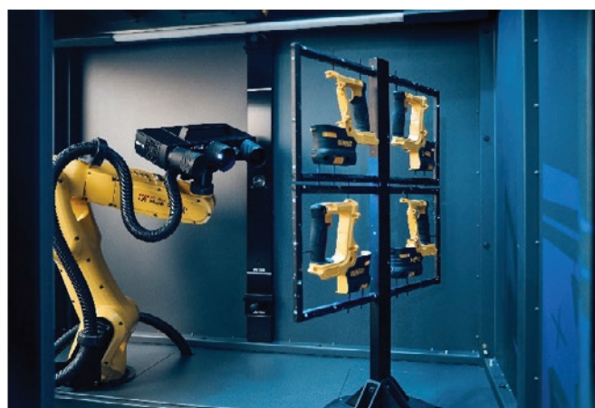
Slika 6: 3D digitalizacija polimera i odljevka
