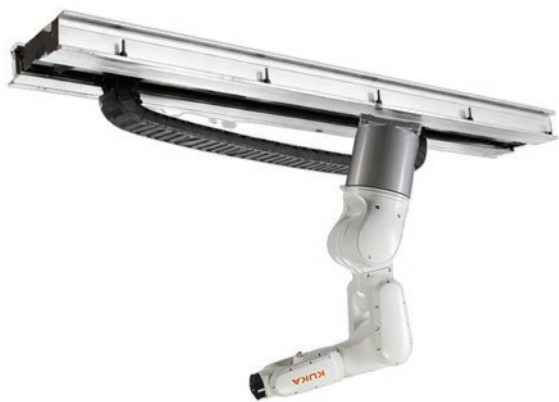
Slika 1: Zgradba robotskega sistema - zgoraj linearna tračnica, spodaj robot KR10 R900.
