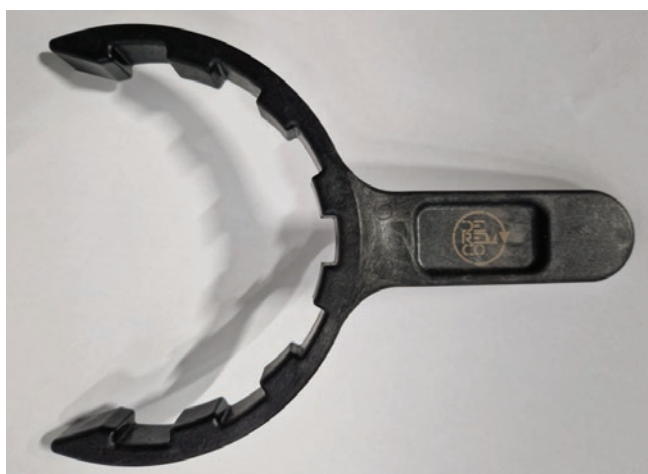
Slika 4: Montažni ključ za filter za vodo brizgan v podjetju O.P.S. Breznik d.o.o.
