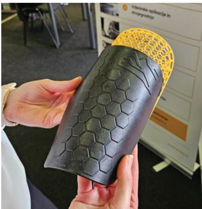
Slika 6: Flexprotec ščitnik sestavljen iz recikliranega termoplastičnega kompozita (črni
