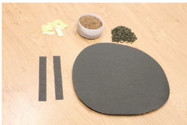
Slika 1: Odpadni trakovi PP (levo zgoraj), odpadnih kokosovih vlaken (sredina zgoraj), granulati biokompozita s 20 % odpadnih kokosovih vlaken (desno zgoraj), in kompozitna plošča (desno spodaj)
