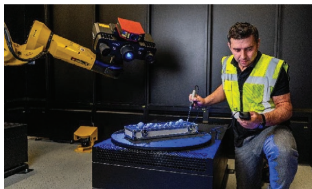
Strokovnjak podjetja TOPOMATIKA Tomislav Petrić posnet med preverjanjem točnosti merilnega sistema s pomočjo standardiziranega artefakta
