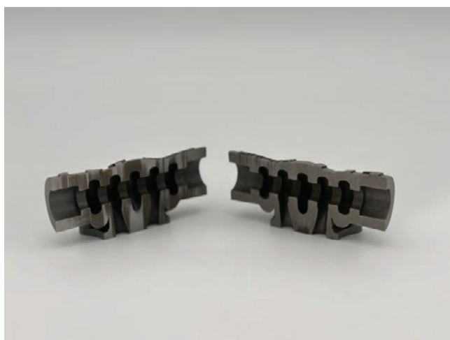
Slika 3: Prerez 3D natisnjene proporcionalnega ventila
