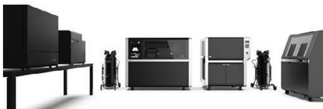
Slika 2: Stroji za postopek MBJ (od leve proti desni): sušilec za aktivacijo veziva, mešalec prahu, 3D tiskalnik, peč za sintranje, enota za razpraševanje
