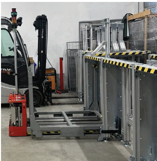
Slika 5: Testiranje AGV-ja v delavnici
