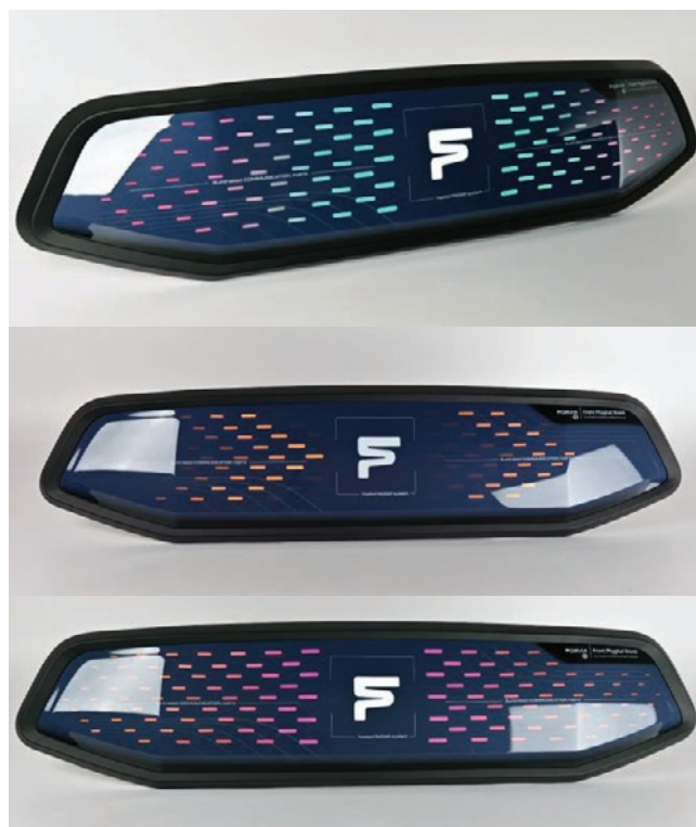
Slika 10: Osvetljen panel glede na svetlobno funkcijo [5]
