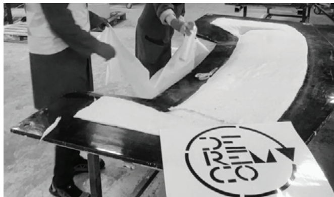
Slika 5: Polaganje termično reciklirane mate v kalup
