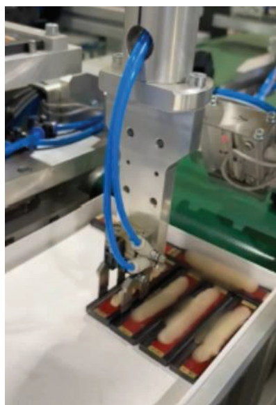
Slika 4: Vakumsko prijemalo z avtomatsko menjavo
