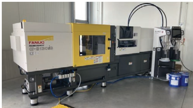
Slika 1: FANUC Roboshot demo brizgalni stroj zapiralne sile 130t
