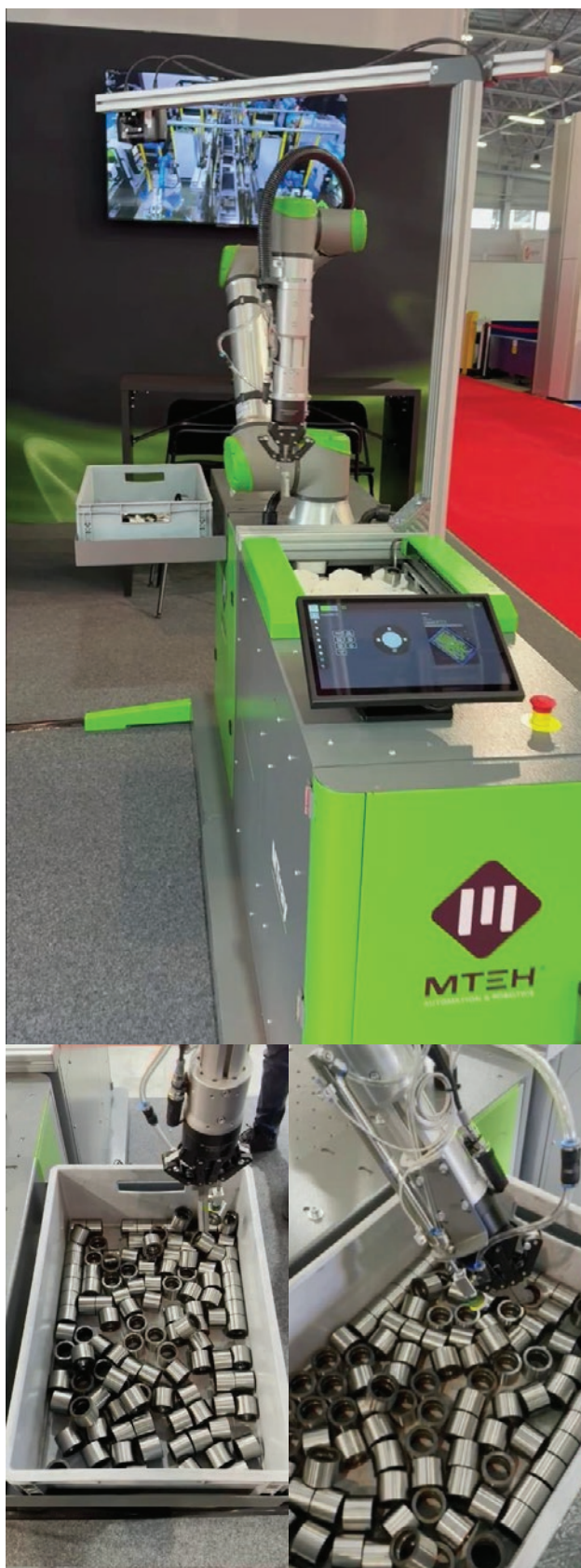
Slika 9: Integracija sistema v modularno kolaborativno celico
