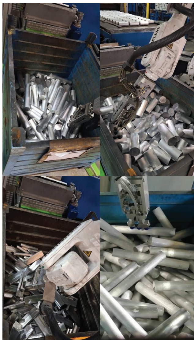
Slika 8: Pobiranje aluminijastih palic okroglega in eliptičnega preseka v proizvodnji
